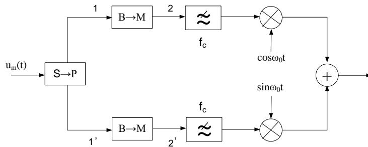
2. Na slici je prikazana blok šema sistema za prenos digitalnih signala. Na ulaz predajnika dolaze 4 nezavisna binarna signala. Svaki od ovih signala u intervalu vremena  $kT \leq t \leq (k+1)T$ ,  $k=0, \pm 1, \pm 2, \dots$  može imati vrijednosti +1 ili -1 sa jednakom vjerovatnoćom.
